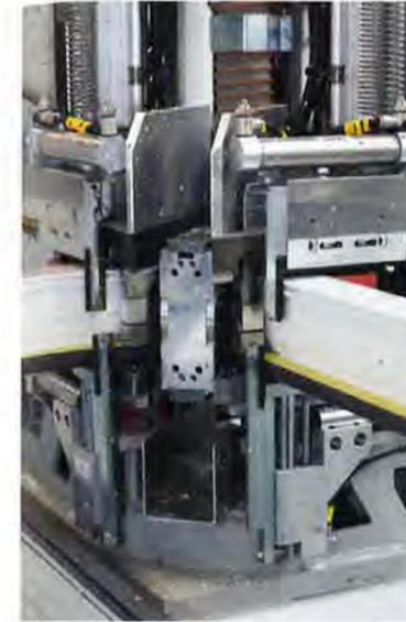
*Die neue Schweißtechnik liefert die Präzision, die für eine funktionierende Verklebung notwendig ist. In der Bildmitte ist der Fräskopf zu erkennen.*
