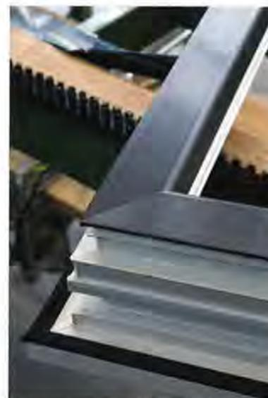
Fensterelement mit Gealan-acrycolor-Oberfläche, geschweißt mit der neuen Urban Cut Technologie. Fotos: bauelemente bau
