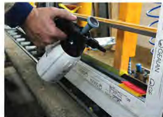
Bei sämtlichen Fenstern und Balkontüren werden die Scheiben verklebt. Dabei setzt der Fensterbauer auf die Statische-Trocken-Verglasung STV® von Gealan.
